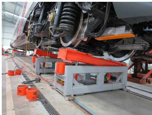
Pro schválení nového vozidla je třeba řada obsáhlých zkoušek; podmínky mnoha z nich, především těch z oblastí bezpečnosti vozidla proti vykolejení, shrnuje ČSN EN 14363+A1. Na obrázku měření náklonu patrového vozu. (© VÚKV a.s.)
