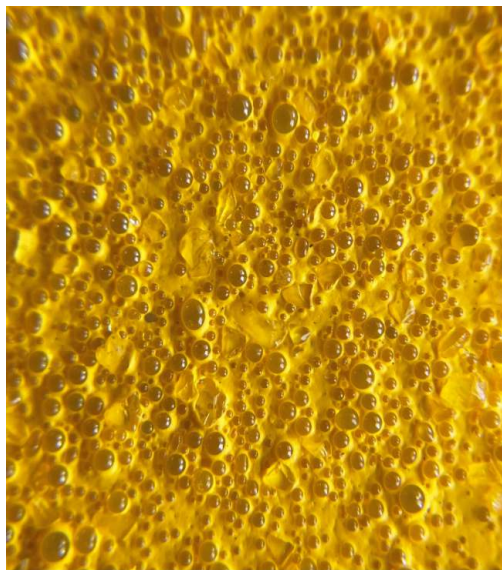
Obr. 2 Detail přechodného značení z barvy s posypem ze směsi balotiny a zdrsňujících přísad
