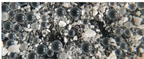
Obr. 12 Směs balotiny a zdrsňujících přísad
