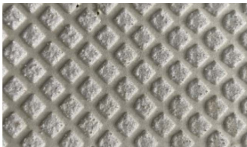
Obr. 11 Detail fólie pro stálé vodorovné dopravní značení
