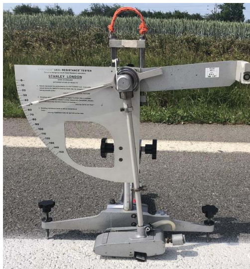
Obr. 6 Měření drsnosti kyvadlem na zkušebním úseku
