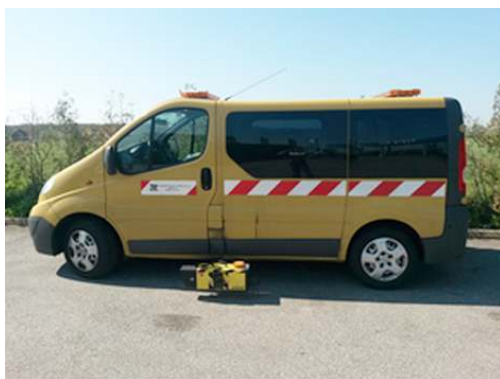
Obr. 3 Měření noční viditelnosti – retroreflexe retroreflektometrem LTL-X na zkušebním úseku a LTL-M umístěným na vozidle pro mobilní měření
