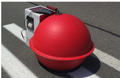
Obr. 4 Měření denní viditelnosti na zkušebním úseku retroreflektometrem QD 30
