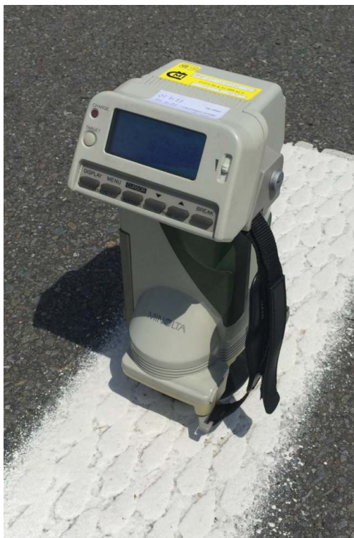
Obr. 5 Měření trichromatických souřadnic x y spektrofotometrem na zkušebním úseku
