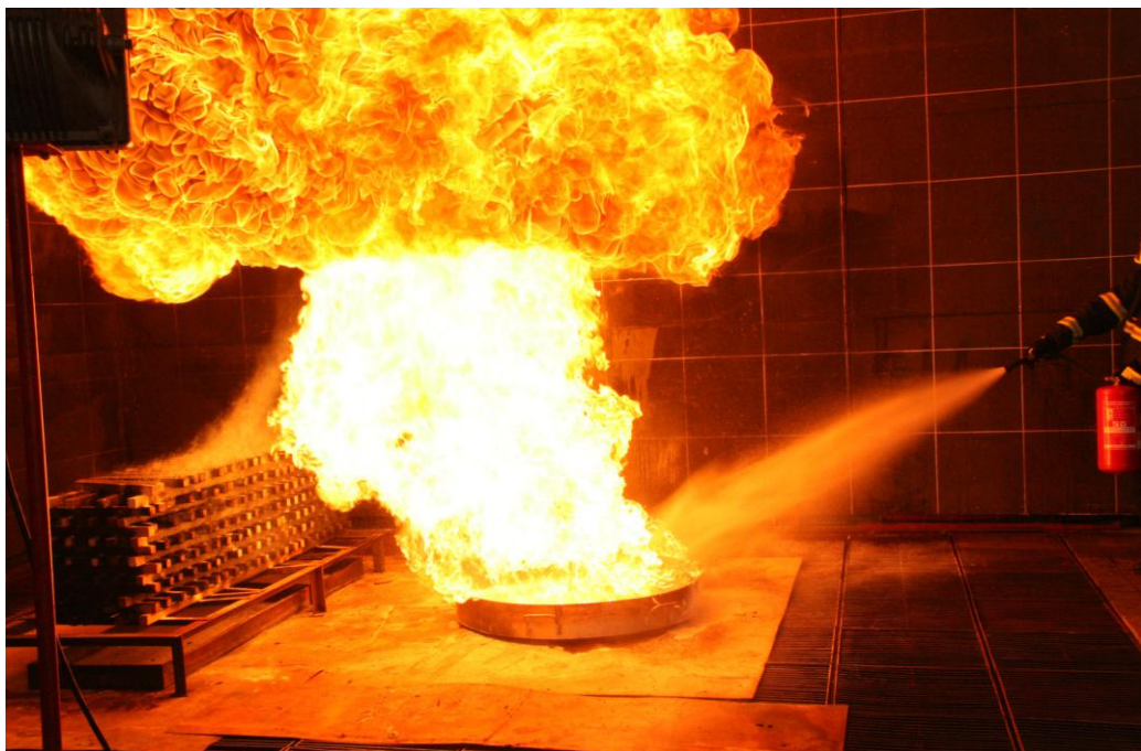
Obr. č. 2 Zkoušky hasební účinnosti hasiva na požáry typu B
