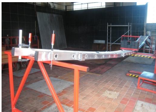
Obr. č. 3 Zkouška pevnosti přenosného požárního žebříku
