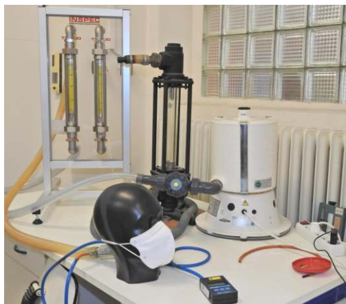
– Měření dýchacích odporů
