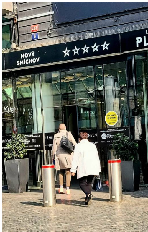
Bezpečnostní prvky (sloupky) k zajištění ochrany proti proniknutí jedoucího vozidla do prostoru obchodního centra (2022, z archivu autorky)
