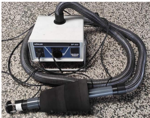
Aparatura na měření těsnosti. Zdroj: SZU
