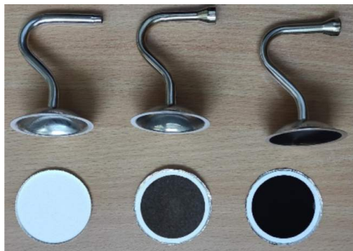
Filtry na prachové částice: čistý, středně zanesený, zanesený. Zdroj: SZU
