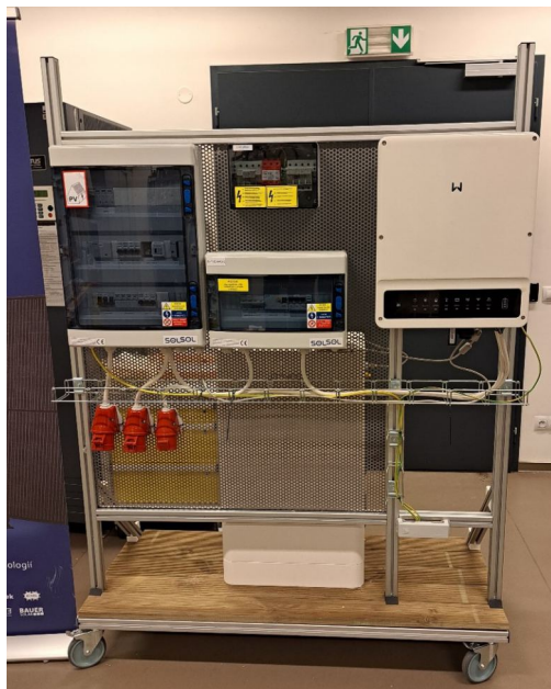
Výukový a zkušební polygon s rozváděči a PV střídačem zdroj: UCEEB
