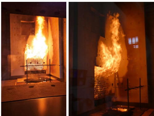
Obr. 2, 3 – průběh velkorozměrové zkoušky ETICS
