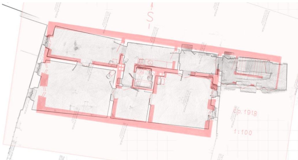
Průhledové zobrazení – 2D výstup ze skenu v porovnání s původním půdorysným schématem
